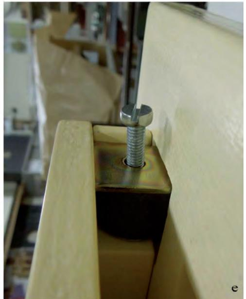
Fig. 5 I dispositivi elastici con la loro collocazione sul pannello di contenimento.
